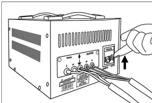
Рис. 8. Включение стабилизатора
