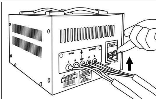
Рис 11. Включение стабилизатора
